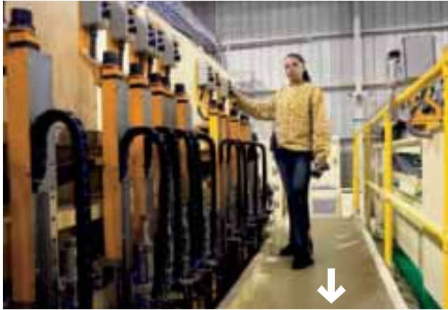
En medio del proceso de fundición, una operadora ajusta la distancia de la roleta de corte para que el vidrio fabricado salga con las medidas correctas.
