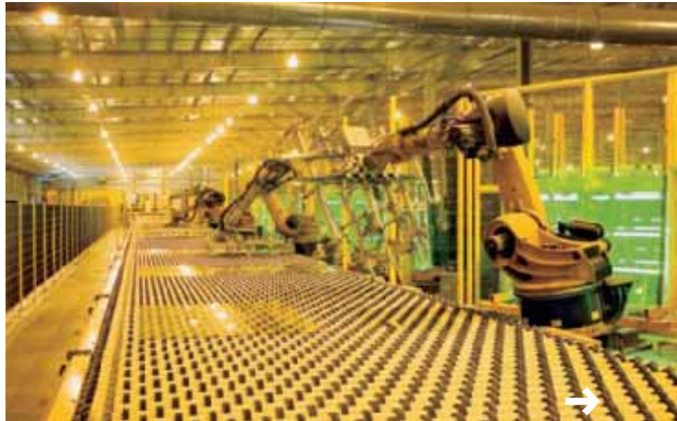
Robots que soportan de 80 a 350 kg levantan de la línea de producción hojas de vidrio de hasta 6 m de largo y las acomodan para su empaque.
